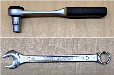
Steckschlüssel SW13 oder Ring-Gabelschlüssel SW13
